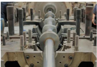
D-4102. Deshidratador: Inspección REP Nivel C + revisión mayor agitador + revisión programada 12 años motor.
